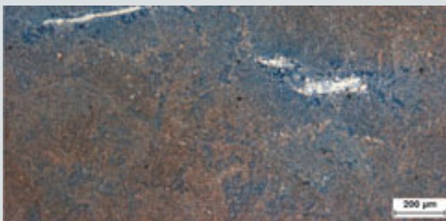
Werkstoff-Nummer 1.2316 Martensitisches Gefüge mit Deltaferritanteilen / Martensitic structure with delta ferrite content
